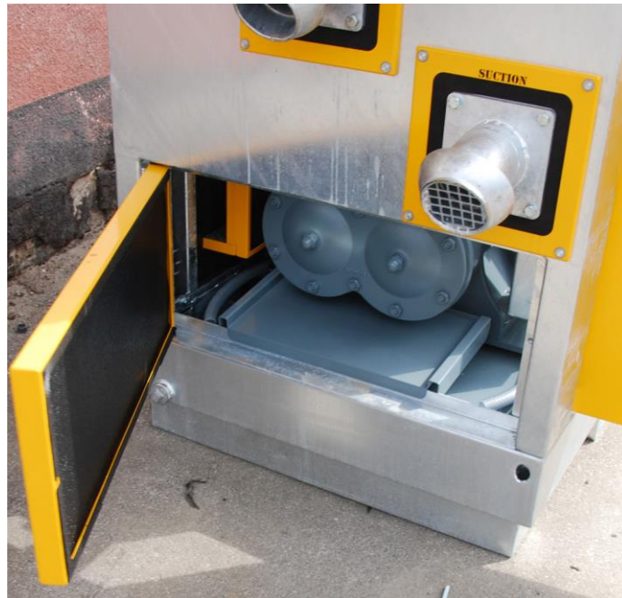
Przyłącza ssawne i tłoczne wyposażone w szybkozłącza. Łapacz kamieni na ssaniu. Wygodny dostęp do rewizji sekcji cylindrów.
